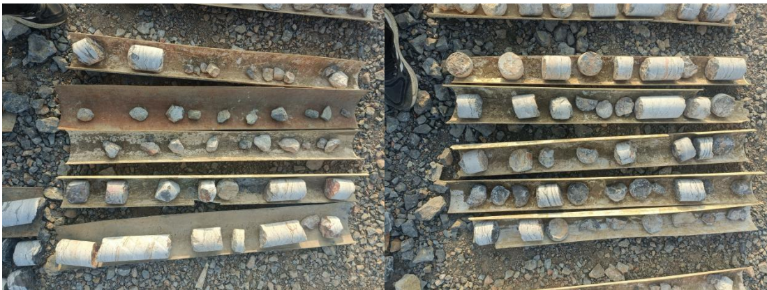
图 3-2 边坡勘察 ZK1 钻孔 46-55m 岩心照片
